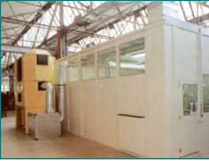
Cabinas de separación para trabajos de carpintería
